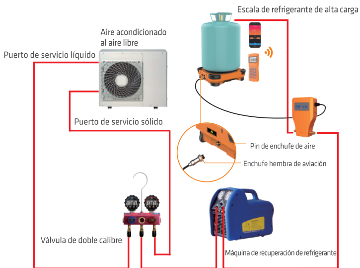
Diagrama de recuperación de refrigerante
