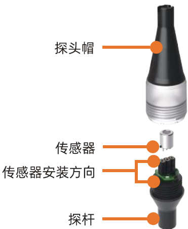
ELD-270传感器安装示意图
